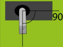
Valve inclinée à **90 degrés** par rapport au sens de la chambre à air
