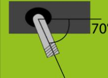
Valve inclinée à **70 degrés** par rapport au sens de la chambre à air
