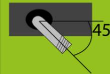
Valve inclinée à **45 degrés** par rapport au sens de la chambre à air
